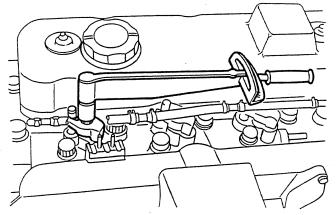
TORQUING THE FUEL INJECTOR HOLDER BRACKET
